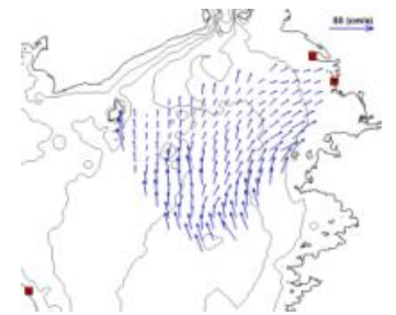
図3 押し波（第2波）の流速ベクトル。
