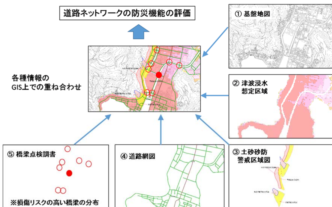
図 4-4 情報の重ね合わせの処理イメージ
