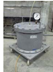
アウトプット法による透気試験
