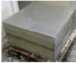
3層コンクリート供試体
