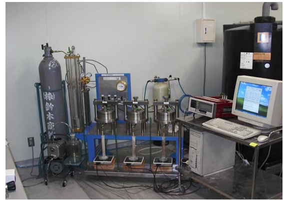
図-18 透水試験装置の外観
